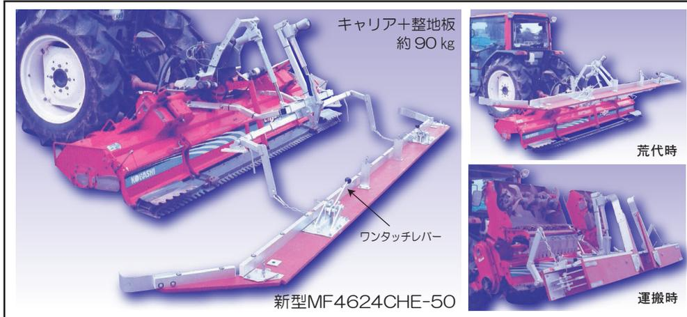
①トラクターのオート装置を入れ代掻作業をしながら手元の操作スイッチで整地板の高さ調整(仕上・土寄・仕上)がトラクターを止めることなくでき短時間で均平な代掻作業ができます。
